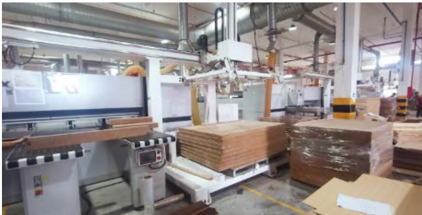
Hình 1.5. Khu vực máy cắt và đường ống thu gom bụi
