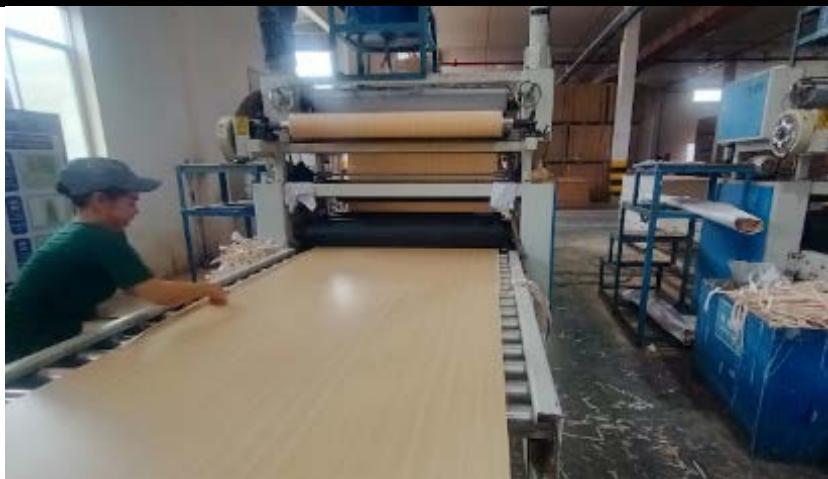
Hình 1.6. Cắt giấy dán bề mặt
