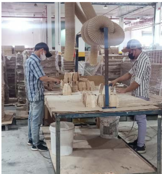
Hình 1.9. Công đoạn chà nhám các chi tiết
